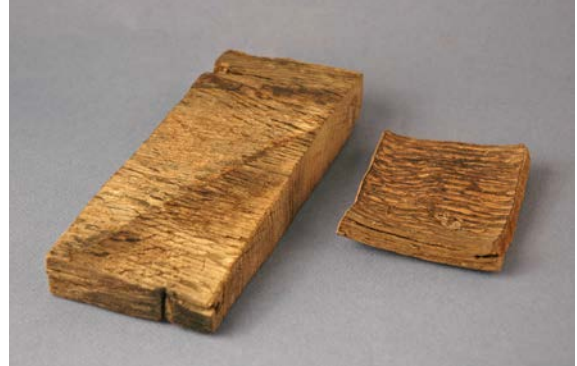
De två trästyckena var från början i samma storlek. Trästycket till vänster har konserverats. Trästycket till höger har fått torka okontrollerat utan någon konservering och har därmed deformerats och fullständigt förlorat sin ursprungliga form.
