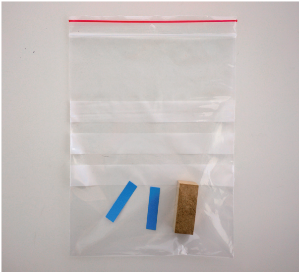
AD-remсор kan användas för att ta reda på om material för utställningar, förvaring och packning av museiföremål avger sura gaser. På bilden har en bit av ett konstruktionsmaterial för utställningsmontrar placerats i en förslutningsbar påse av polyeten. Foto: Elyse Canosa.
